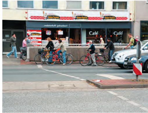
1 Die Haltlinie für Radverkehr liegt deutlich vor der des Kfz-Verkehrs und unmittelbar vor der Fußgängerfurt.
