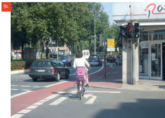
9a–c Der Radverkehr richtet sich nach dem direkt neben dem Kfz-Signal angebrachten Radverkehrssignal. Ein Hinweiszeichen informiert indirekt links abbiegende Radfahrende, wie sie sich verhalten sollen.
