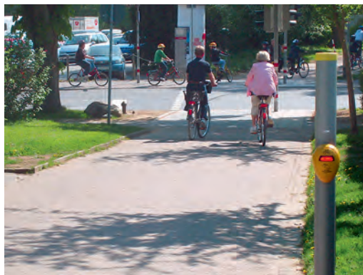
20 Hier quert eine wichtige Wegebeziehung für Fuß- und Radverkehr eine Verkehrsstraße. Mit dem vorgelagerten Anforderungstaster können Radfahrende die signalisierte Querungsstelle in der Regel ohne Halt bei Grün passieren. Nachfolgender Radverkehr kann die Grünzeit verlängern.
