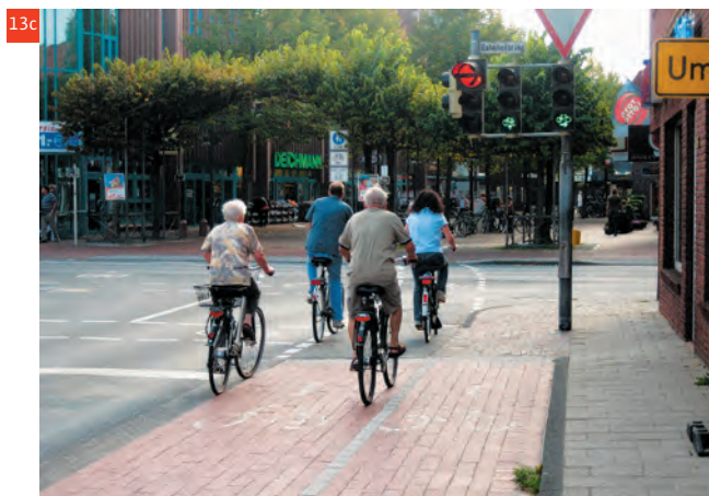
13 a-c Der Radweg wird richtungsbezogen aufgeweitet. Geradeaus fahrender Radverkehr erhält gegenüber dem starken Kfz-Strom nach rechts eine konfliktfreie Phase.
