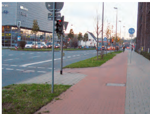
21 Für den Fußverkehr ist ausreichend Platz, um sich zwischen Fahrbahn und Radweg aufzustellen. Der Radverkehr kann ohne Beachtung der Signalisierung frei fahren.
