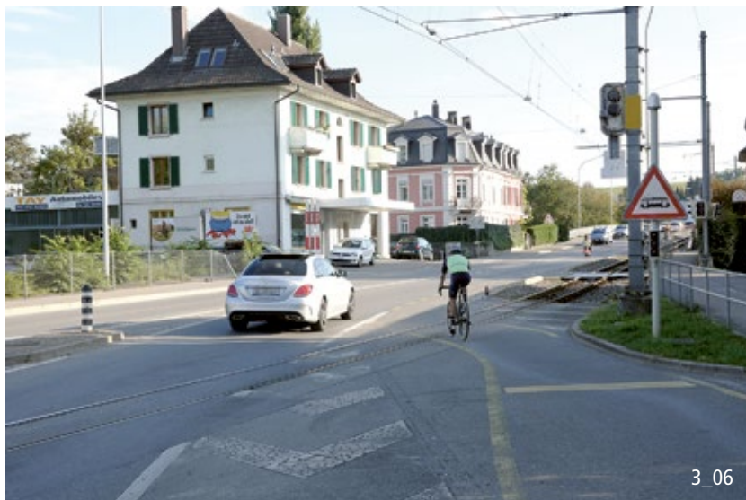
Verbesserung des Querungswinkels abseits des Motorfahrzeugverkehrs.
