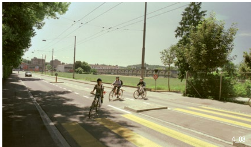
Geschützter Mittelbereich für Linksabbiegen und Einmünden.
