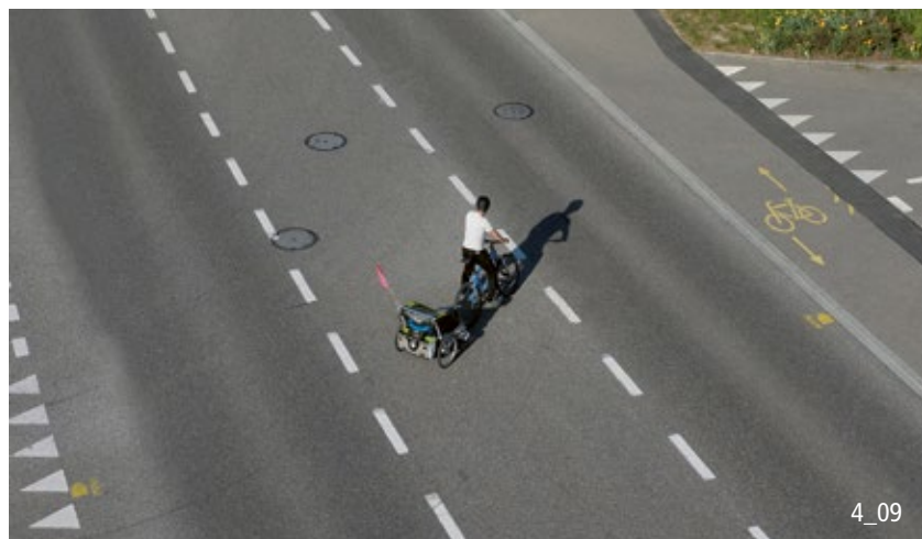
Fahrfluss und Sicherheit des Veloverkehrs können mit Breiten \geq 3.50 m stark verbessert werden.
