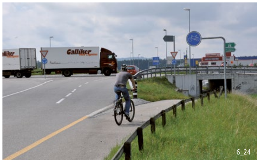
Veloumfahrung des zweistreifigen Kreisels mit niveaufreier Querung.
