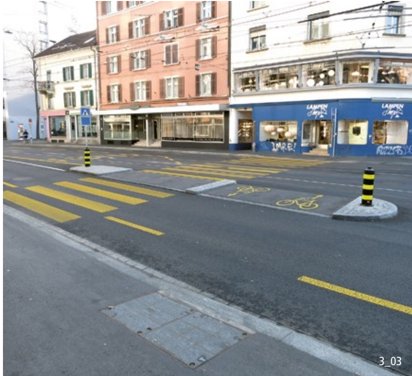
Trennung von Veloverkehrs- und Fussgängerbereich bei Schutzinseln: Velodurchfahrt ohne Kanten.
