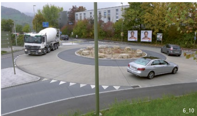
Die schmale Kreiselfahrbahn verhindert das Überholen von Velofahrenden im Kreisel.
