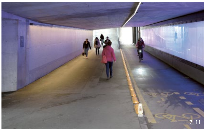
Separate Flächen für Fuss- und Veloverkehr bei mittleren bis hohen Frequenzen.
