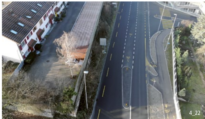
Rückführung des Radwegs auf die Fahrbahn.
