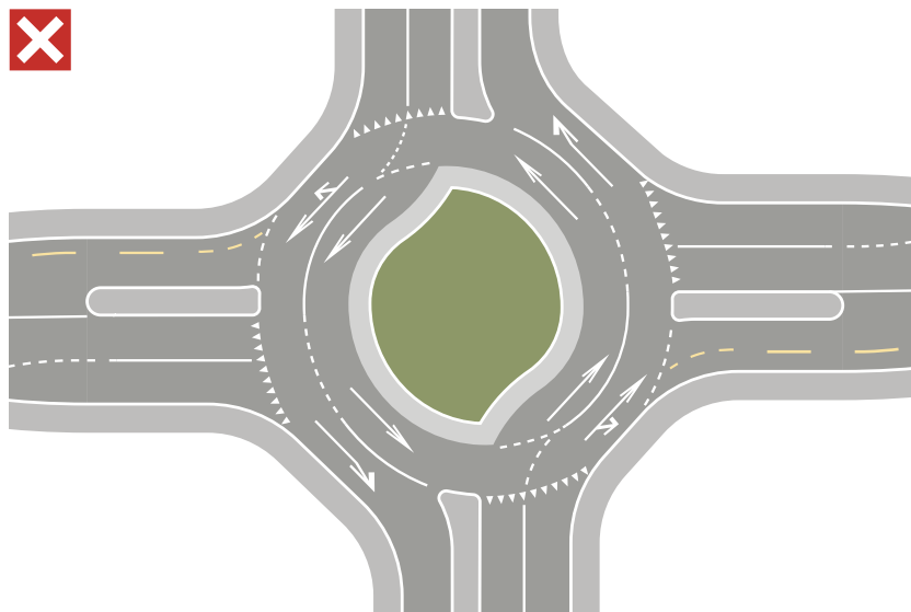
Abb. 631 Turbokreiseln sind zu komplex, deren Befahrung auch für Motorfahrzeuglenkende anspruchsvoll und daher nicht veloverträglich
