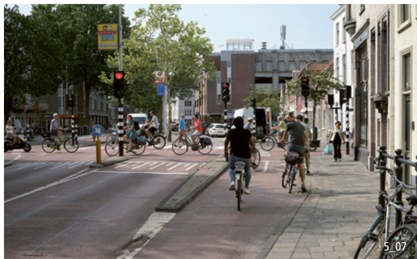
Indirektes Linksabbiegen mit Radweg (Niederlande).
