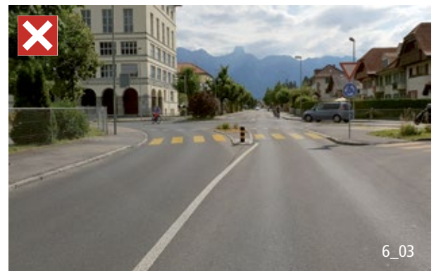
Der Durchschuss erhöht die Geschwindigkeit im Kreisel.
