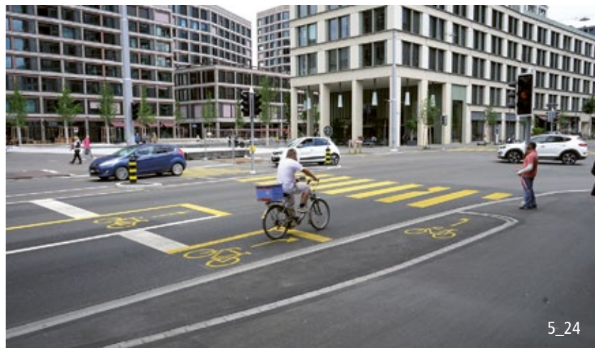
Indirektes Linksabbiegen mit eigener Haltebucht.
