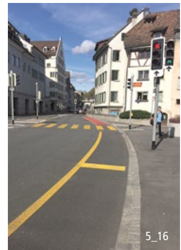
Dauergrün für Veloverkehr geradeaus, Rotlicht nur bei Grünphase Fussverkehr.
