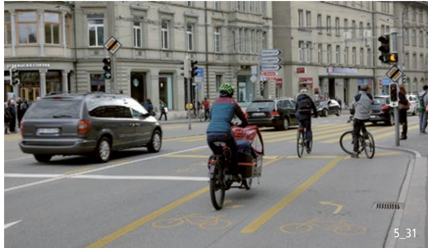
Indirektes Linksabbiegen mit eigenem Radstreifen.
